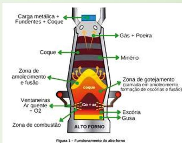
Figura 1 - Funcionamento do alto-forno
