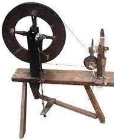
Figura 53 – Roca para processar algodão
