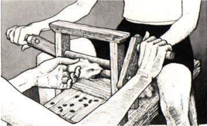
Figura 54 – Máquina para abrir o algodão no processo de preparar o fio
